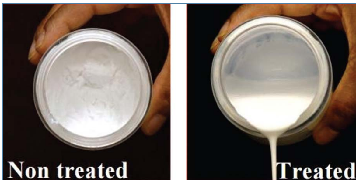
Figura 2 - Le proprietà di flusso del biossido di titanio (15 nm) sono superiori grazie al trattamento di superficie, a base di PEG-8 Metil Etere Trietossisilano, che produce un assorbimento acqua/olio inferiore e una minore viscosità (4)
